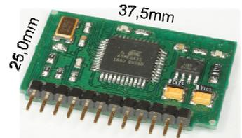
**Produktneuheit:** Alle Sounds können mit einer variablen Abspielgeschwindigkeit (50%...200%) auf verschiedenen "Tonspuren" wiedergegeben werden. Ansteuerung über die serielle TWI-Schnittstelle (I2C). Die Geräteadresse wird in der .ini-Datei (auf der MicroSD) eingestellt. Integrierter Verstärker: 1.5W an 8 Ohm.
